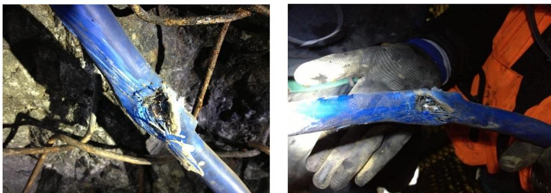
**Figura 5.68.** Ejemplo de corte en el cable *conduit* en el trayecto desde la caja de interconexión al *host* central, generado por una máquina que operaba en el sector, produjo la caída de 3 cajas sísmicas.
