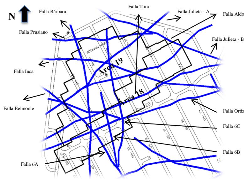
**Figura 2.3.** Fallas mayores existentes en Áreas 18 y 19 del Tercer Panel de la mina Subterránea Río Blanco.
