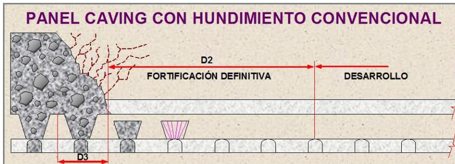
Figura 2.8. Explotación con variante *Panel Caving* Tradicional (Cavieres, 2008).
