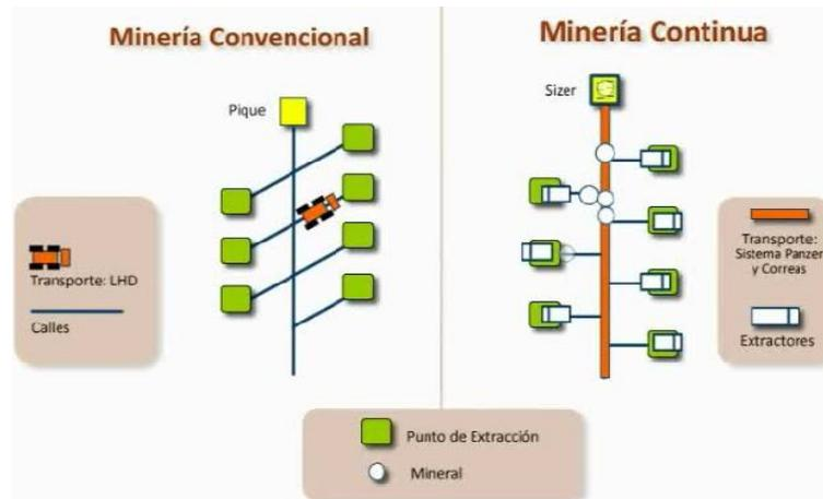
**Figura 3.28.** Comparación en el funcionamiento de la Minería Convencional y la Minería Continua (DAND 2012).
