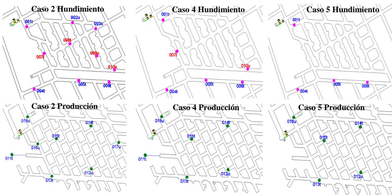
Figura 5.92. Distribución de sensores para los casos 2, 4 y 5, teniendo en cuenta la pérdida de sensores por el avance del Hundimiento e inconvenientes laborales.
