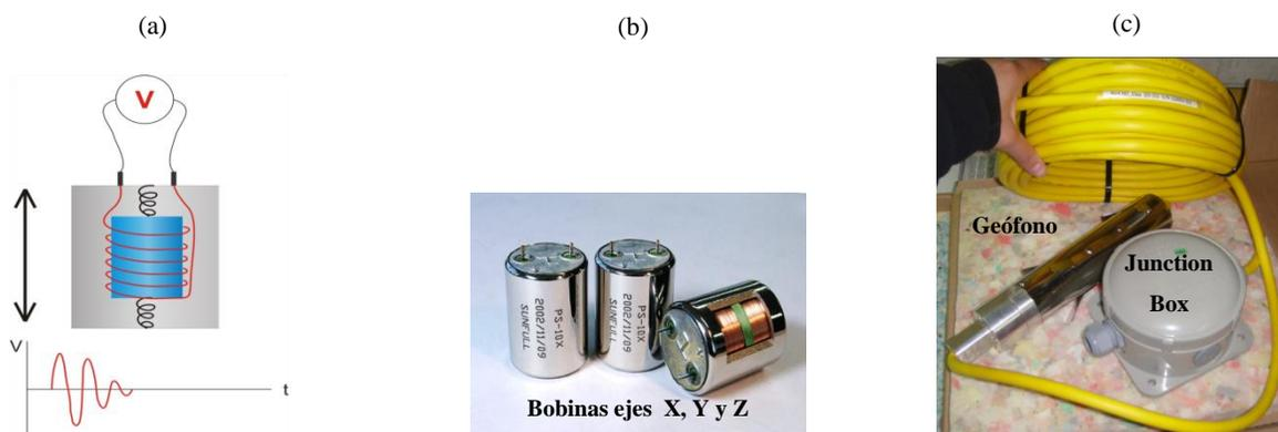
**Figura 3.20.** (a) Esquema simple del funcionamiento interno de un geófono. (b) Bobinas son utilizadas por cada componente. (c) Imagen que ilustra un geófono proporcionado por el IMS junto a su Junction box, que actualmente están instalados en el sector norte del III Panel en la mina subterránea (*Gentileza IMS*).
