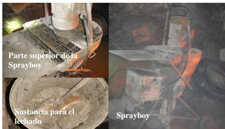
**Figura 5.55.** Ilustración de bomba helicoidal utilizada para la inyección del lechado, sustancia compuesta de cemento y cartón.
